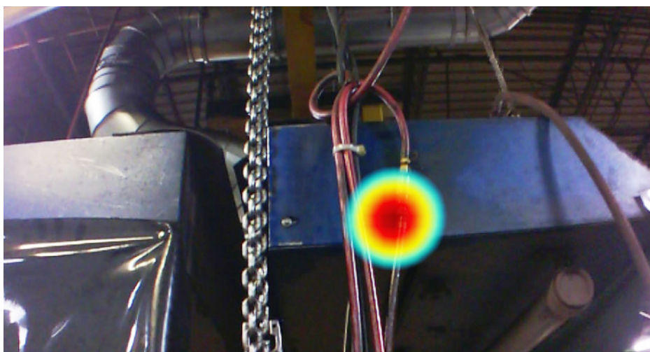
Zdjęcie przemysłowego przyrządu do obrazowania akustycznego Fluke ii900 wykrywającego wyciek powietrza w warunkach przemysłowych.
