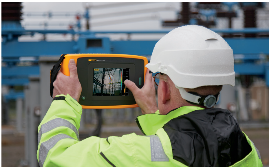
Zdjęcie precyzyjnego przyrządu do obrazowania akustycznego Fluke ii910 wykrywającego wyładowanie niezupełnie w urządzeniach wysokiego napięcia.
